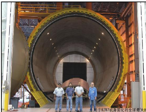
B787机身固化热压罐 \Phi 9m \times 23m
