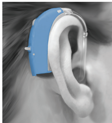
FIGURA 1. Um típico aparelho auditivo BTE inclui microfones, isolamento contra vibrações e um receptor, entre outros componentes. O espaço restrito para tais componentes gera um problemático feedback acústico e mecânico. (Crédito da imagem: Knowles Corp.)
