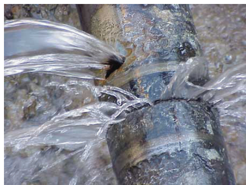
FIGURA 1. Esquerda: Tubo com vazamento sob investigação. Direita: Esquema de configuração de detecção de vazamento. Um vazamento é delimitado por 2 sensores cuja distância é D . O som se propaga nos dois sentidos e um correlacionador mede o tempo que leva para atingir cada sensor. A velocidade do som na tubulação permite localizar exatamente o vazamento.
