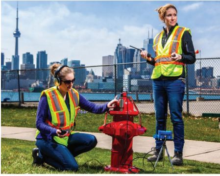
FIGURA 2. O correlacionador de ruído de vazamento LeakFinderSTM™ é compacto e intuitivo.
