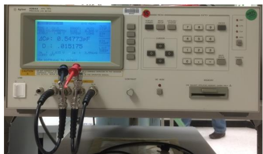
Agilent 4284A 20Hz-1MHz Precision LCR Meter
